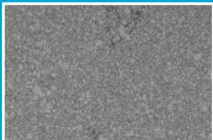
JK101 - комбинация мелкозернистого карбида вольфрама WC и связующего кобальта Co.
